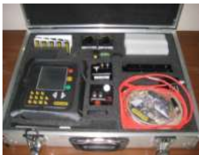
Устройство лазерной центровки валов
