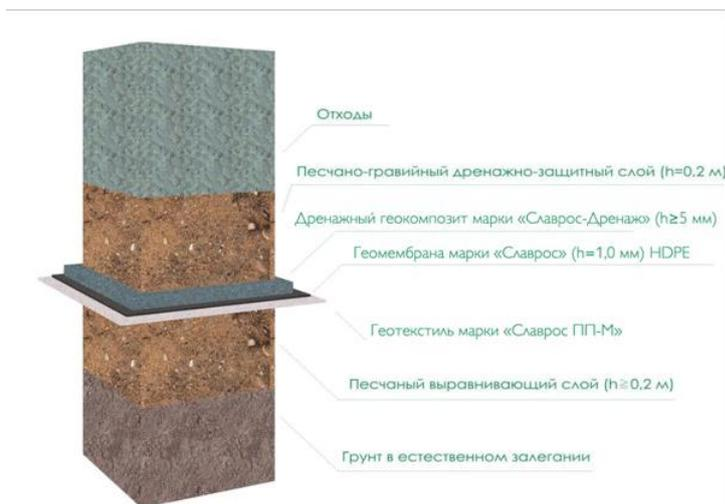
Двухслойный экран включает в себя спланированное основание участка захоронения отходов (естественный грунт), геосинтетическое покрытие на минеральной основе из армированного волокна (бентомат), геомембрану марки «Славрос», слой геотекстиля марки «Славрос» для защиты геомембраны и дренажный песчано-гравийный слой.
