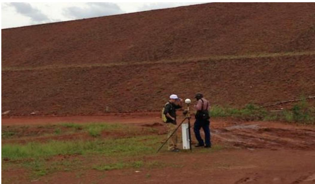
*Рис. 3. Полевой специалист (в белой кепке), записывает измерения магнитного поля, генерируемого электрическим током, проводимого через воду у истока просачивания через плотину*
