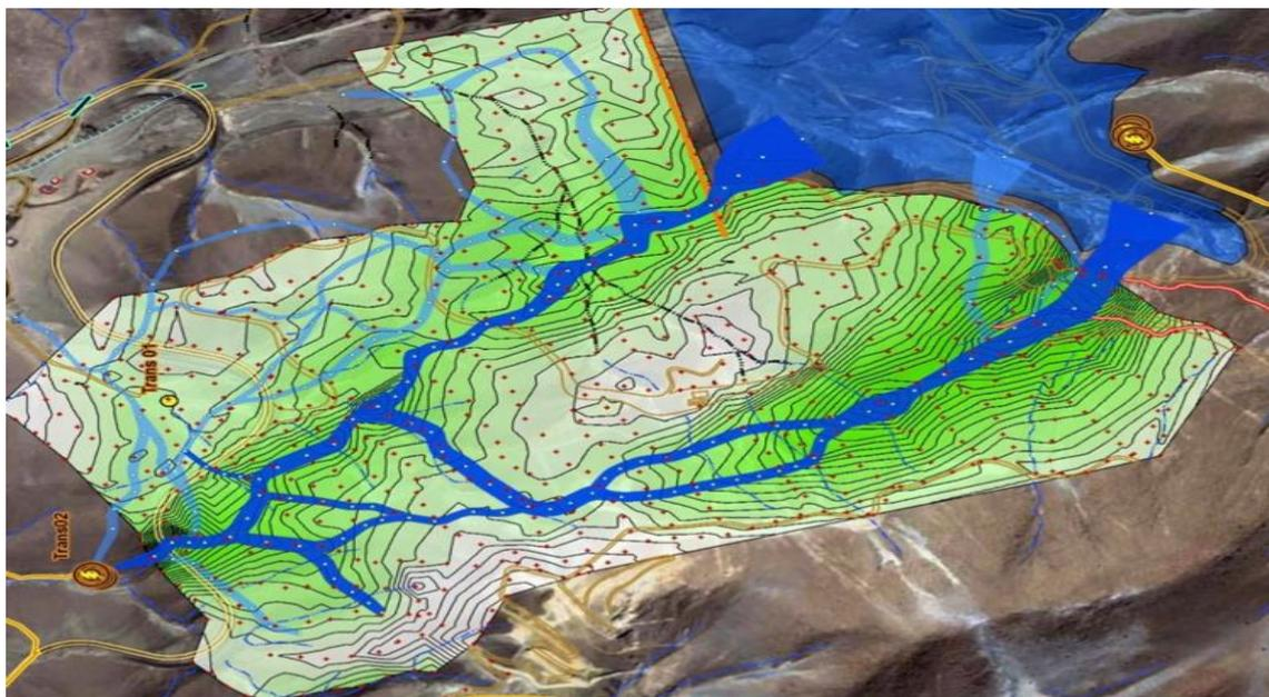
**Рис. 1.** Типичная съемка, получаемая от технологии Willowstick после обработки сигналов от магнитных полей. Темно-зеленый цвет указывает магнитные поля, и синие линии показывают отдельные течения грунтовых вод
