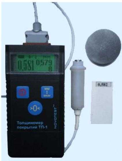
Далее замеры толщины покрытия проводятся либо в обычном режиме, либо с усреднением.
