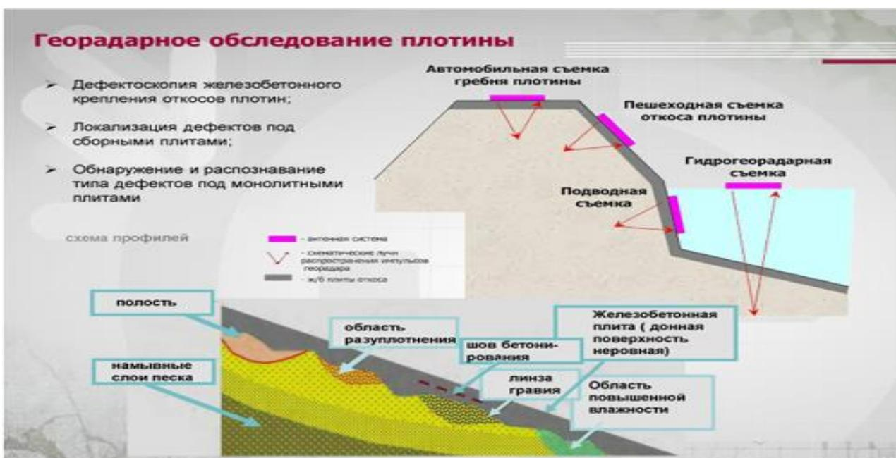
Также сотрудники ГК «Логис-Геотех» проводят обследование железобетонных конструкций гидротехнических сооружений, состояния контакта бетонной конструкции с откосом техногенного массива. Для решения этих задач подходит комплексная методика георадиолокация-сейсмоакустика.
