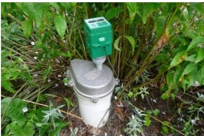
Прибор Well Watch 670 состоит из блока управления и датчика, соединённых между собой с помощью фиксирующего элемента. Блок управления содержит управляющую электронику, процессор, дисплей и кнопочную панель, в то время как датчик содержит динамик, микрофон и резьбовую монтажную горловину, с помощью которой осуществляется подсоединение к тестовой трубе.
