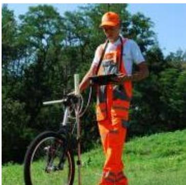
Методом магнитной памяти металла называют метод неразрушающего контроля, основанный на регистрации распределения остаточной намагниченности металла в зоне дефекта (зоне высокого магнитного сопротивления), возникающей под действием технологических и эксплуатационных факторов
