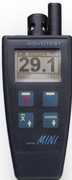
Калькулятор точки росы NOVOTEST KTP-1 предназначен для оперативного неразрушающего контроля температуры и влажности воздуха, расчета температуры точки росы и измерения температуры поверхности контактным методом.
